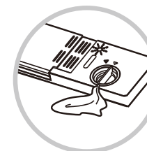
把如果不小心将漂洗剂溢出，请用湿抹布将溢出的漂洗剂擦干净
